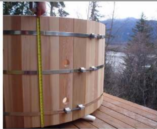
Figuur 7.2 Verdeel de duigen gelijk over de Hot Tub
